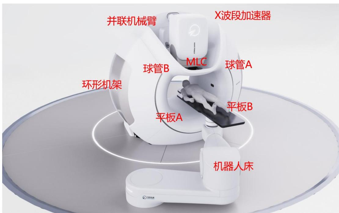
图 9-2 机器人放疗系统示意图
